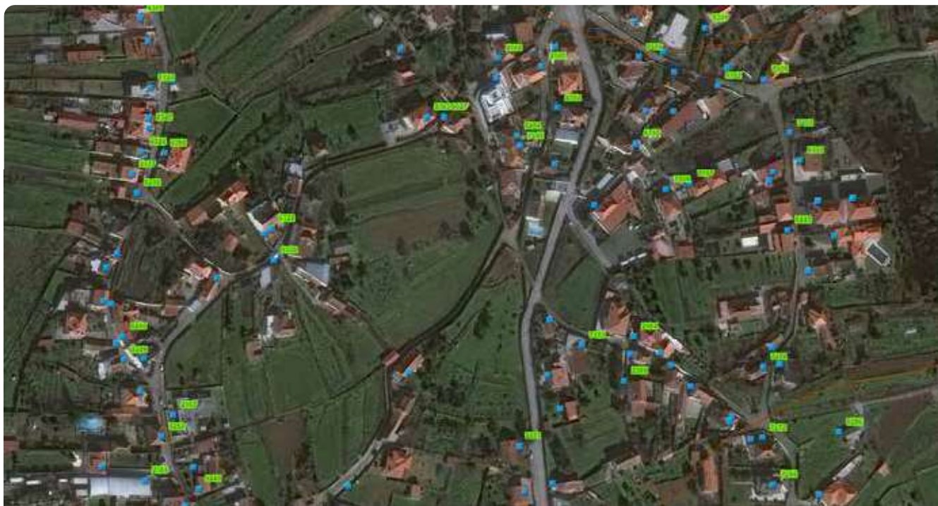
Figura 24/ Ilustração da interface de consulta da base de dados georreferenciada dos números de série RFID das habitações dos utilizadores dos SMSBVC
